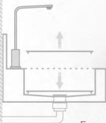
Esquema da bancada com queda para a válvula oculta.
